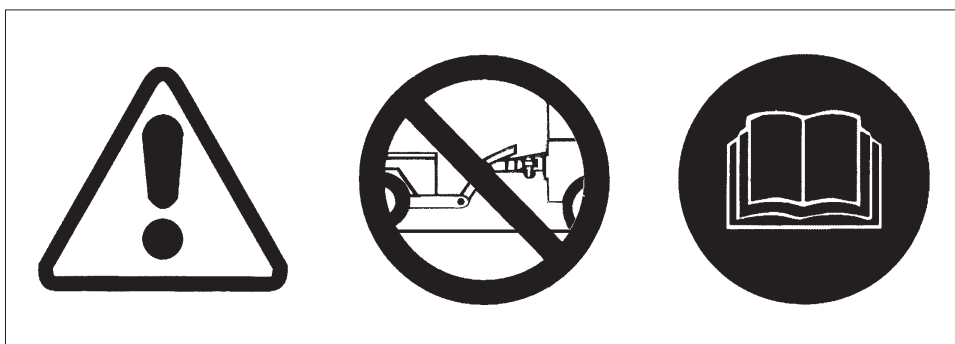
Respeitar o manual de instruções antes de proceder ao engate e reboque da máquina.
