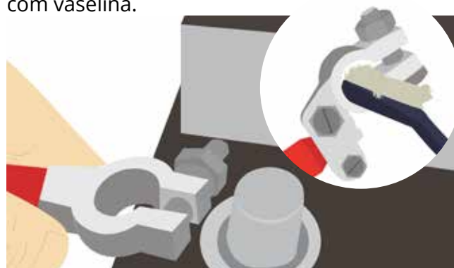
Figura 20 - Limpeza das baterias
