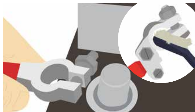
Figura 20 - Limpieza de las baterías
