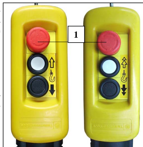
Fig. 2 botão de DESACTIVAÇÃO de EMERGÊNCIA
