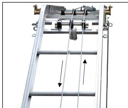
Fig. 37 condução do cabo no cotovelo
