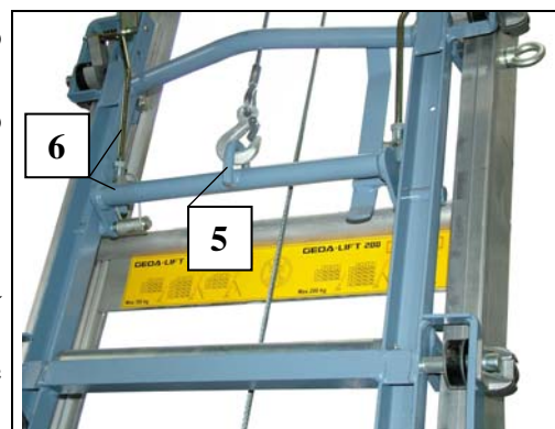
Fig. 38 engatar o cabo no carro
