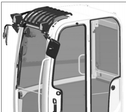
ver a fig. 82:com grelha de protecção FOPS
