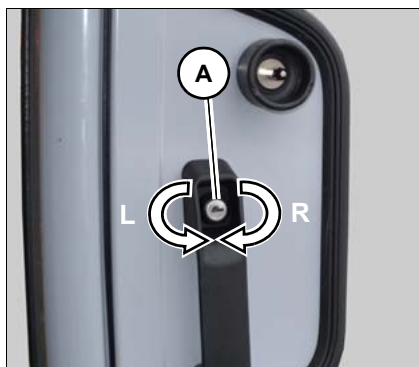
ver a fig. 47: abertura e travamento exterior das portas
