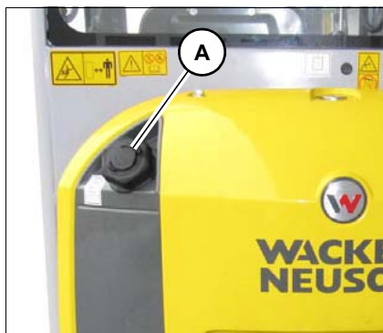
ver a fig. 236:Abastecer de combustível
