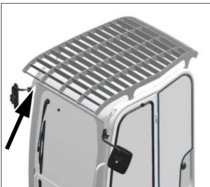
ver a fig. 8: Placa de características FOPS - grade grande
