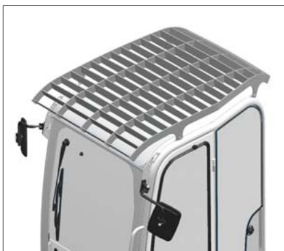
ver a fig. 86:com grelha de protecção FOPS
