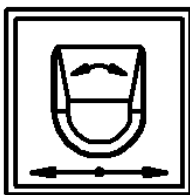
ver a fig. 22:Oscilar a caixa de carga basculante
