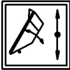
ver a fig. 9:Bascular a caixa de carga basculante
