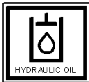
ver a fig. 8: Depósito hidráulico
