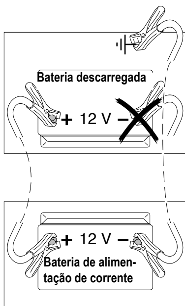
ver a fig. 31:Dispositivo auxiliar de arranque com cabo de ligação
