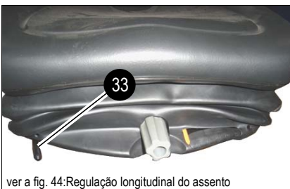
ver a fig. 44:Regulação longitudinal do assento
