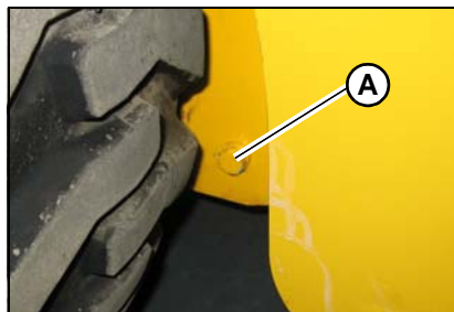
Figura 95 – Localização do bujão de drenagem do óleo do motor remoto no modelo R165
