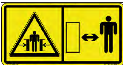
Fig. 19: Perigo de esmagamento na área de perigo
