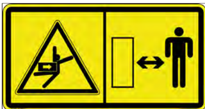
Fig. 18: Perigo de esmagamento na área de perigo
