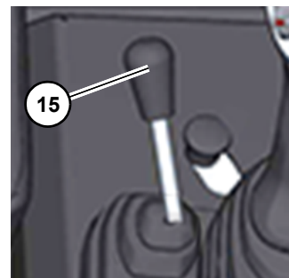
Alavanca para caixa de carga basculante giratória alta
