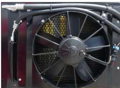
Fig. 286: Condensador de ar condicionado
