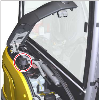
Fig. 250: Abertura do orifício de enchimento de óleo hidráulico
