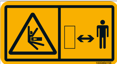
Fig. 18: Perigo de esmagamento na área de perigo
