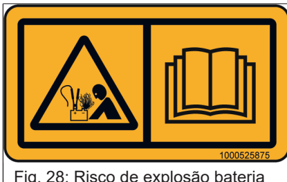
Fig. 28: Risco de explosão bateria
