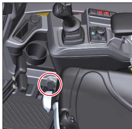
Fig. 285: Tomada de 12V cabine
