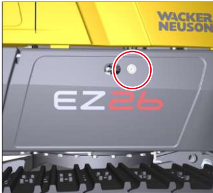
Fig. 244: Tampa de manutenção 2
