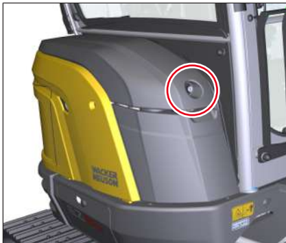
Fig. 245: Tampa de manutenção 3
