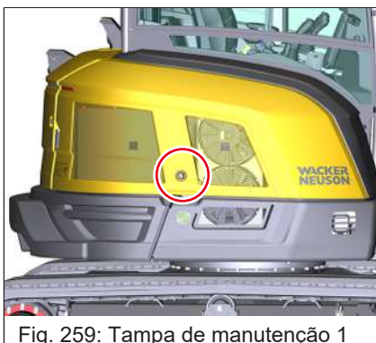
Fig. 259: Tampa de manutenção 1
