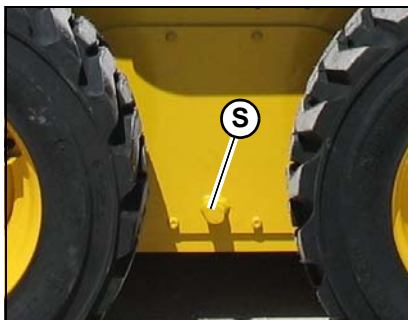
Figura 112 – Bujões de enchimento/verificação das caixas de correntes
