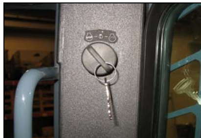
Figura 54 – Interruptor da chave de ignição
