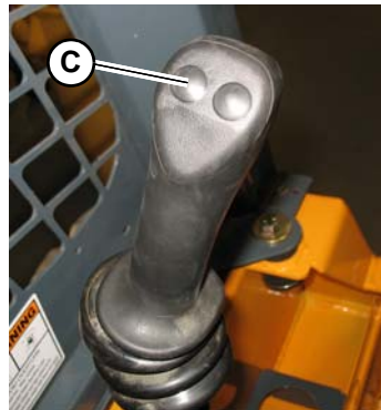
Figura 34 – Botão de comando da transmissão de duas velocidades
