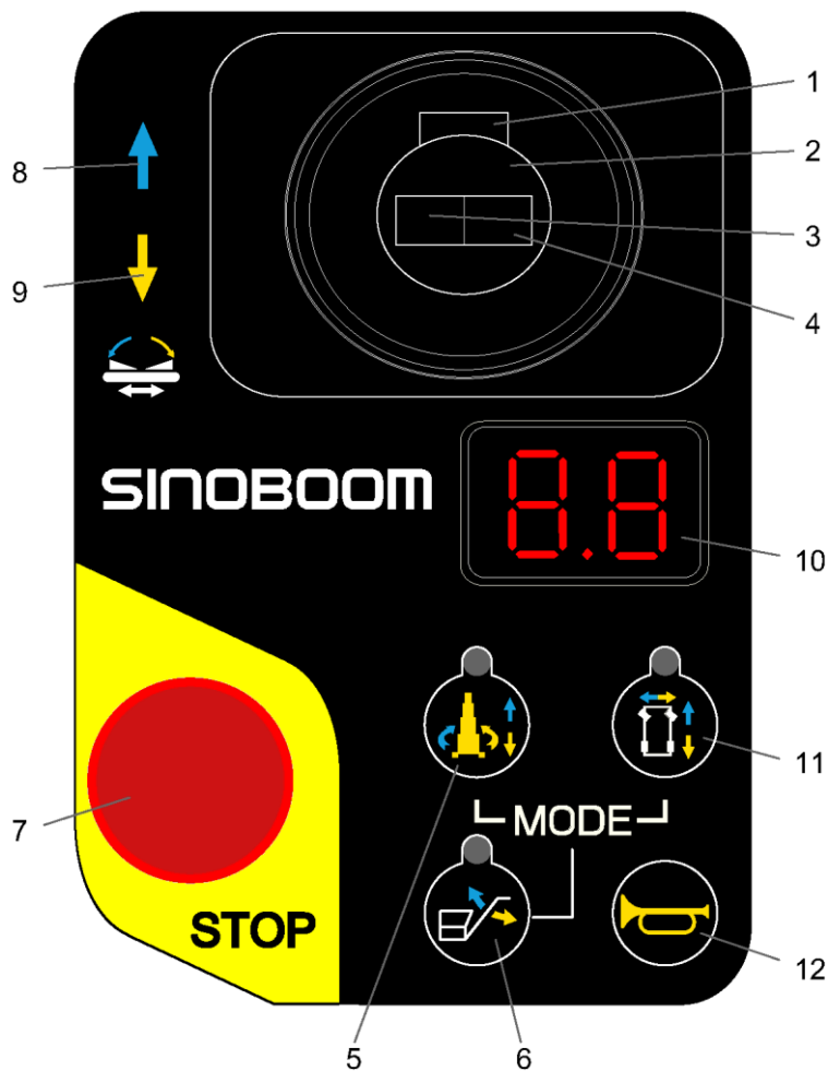
Figura 6-4 Controlador da plataforma
