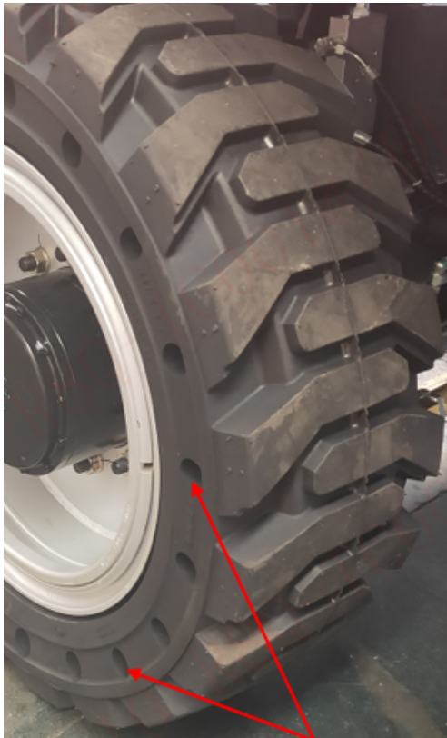
Figura 4 Orificios de ventilación
