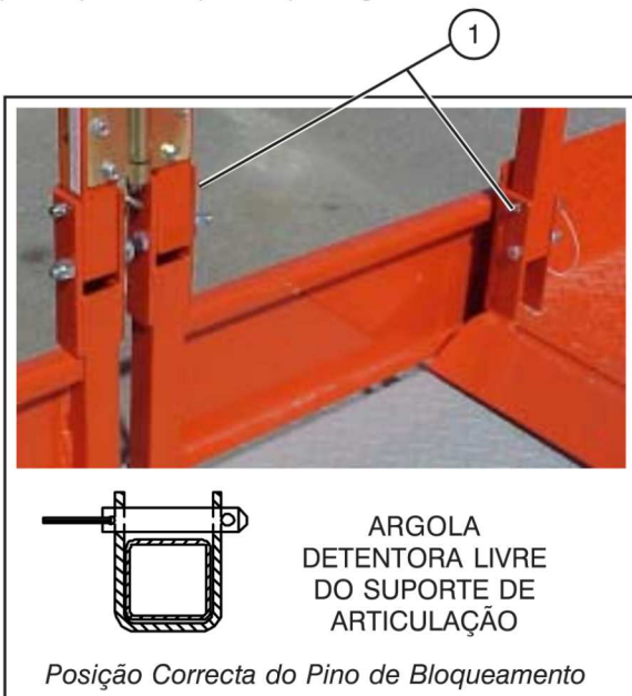
Figura 2-8 Sistema de Rebatimento da Balaustrada
