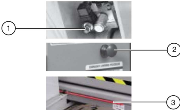
Figura 2-14. Sistema de Descida de Emergência
