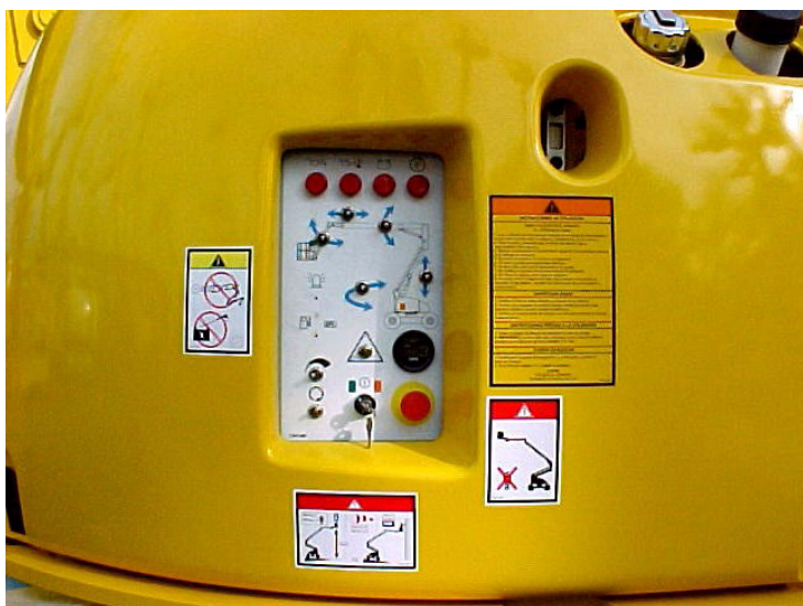
Foto 4 Painel de comando Torre.
