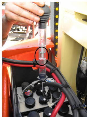
Figura 6-8. Medição da gravidade específica do electrólito
